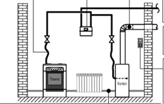
Внутренние газопроводы прокладывают на расстоянии: - не менее 150 мм по горизонтали и 100 мм по вертикали от трубопроводов систем отопления, водопровода, канализации
