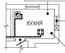
В помещении с газоиспользующим оборудованием должен быть оконный проем с площадью стекла из расчета не менее 0,03м<sup>2</sup> на 1м<sup>3</sup> объема помещения, но не менее 0,8 м<sup>2</sup> (к примеру 0,8м x 1,0м)
