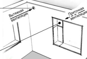
Источником **приточной** вентиляции в жилых домах являются открытые оконные проемы (форточки), неплотности в дверных и оконных проемах, специальные устройства (приточные клапаны).
