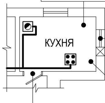
В помещении с газоиспользующим оборудованием должен быть оконный проем с площадью стекла из расчета не менее 0,03м<sup>2</sup> на 1м<sup>3</sup> объема помещения, но не менее 0,8 м<sup>2</sup> (к примеру 0,8м x 1,0м)
